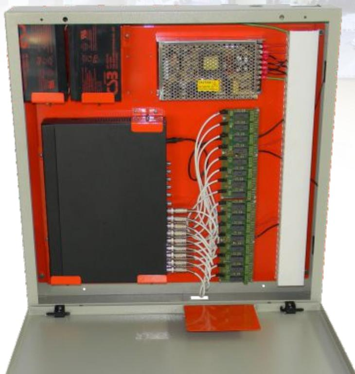
São Montados com Fontes Eletrônicas (tipo Colmeia), Placa de acoplamento ao DVR de 8 canais com ballun passivo e fusível, chassis de aço com pintura eletrostática e tratamento anti-ferrugem. Ventilação forçada por 2 coolers. Suporte móvel para mouse. Fechadura com chaves.
